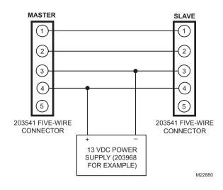
Fig. 20. Cloning jig.
