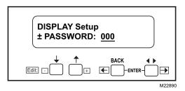
Fig. 21. Display Setup screen.
